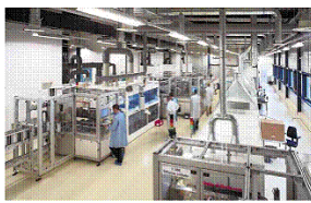
Blick in die Produktionslinie findet die Artenbestimmung der Zellen statt, rechts werden die Wafer dekoriert, links sind nur noch die Durchlaufstationen zu sehen.
