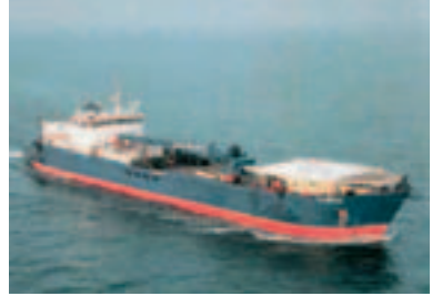
5.19 Verkabelungsschiff mit speziellem Gerät: Damit werden die Kabel einen Meter in den Boden versenkt.
