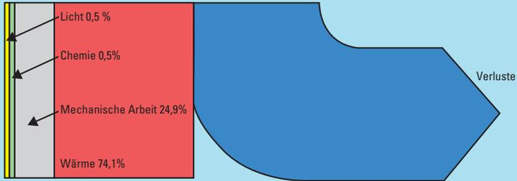
Energieflussdiagramm der Schweiz (1997). Nur 41 Prozent der gehandelten Energie wird in Nutzenergie (Licht, Prozesse, mechanische Arbeit oder Nutzwärme) umgewandelt. Rechnet man noch die Verluste der Öl-, Gas- und Urangewinnung dazu, sinkt der Gesamtwirkungsgrad unter ein Drittel! So geht nicht nur viel Energie, sondern auch viel Geld verloren. Quelle: Gesamtenergiestatistik 1997.
