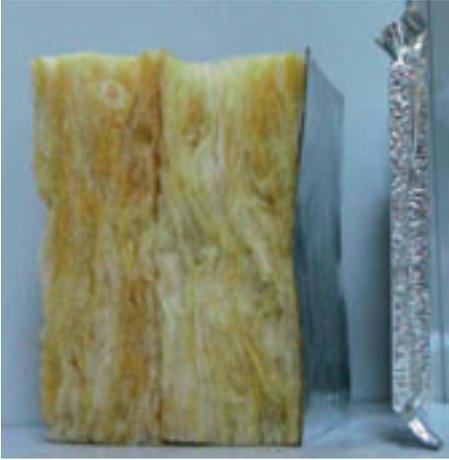
3.3 Beispiele für Ressourcenproduktivität: Die Vakuum-Dämmung rechts hat dieselbe Wirkung wie die Steinwolle-Isolation links im Bild, spart aber nicht nur Energie, sondern auch Raum.<sup>8</sup>
