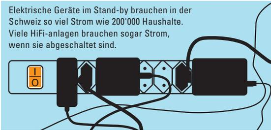
7.24 Einfachste Massnahmen wie zum Beispiel eine Steckleiste mit Schalter können den Standby-Konsum reduzieren.
